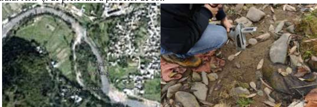
Figura 5 Imagini din zonele investigate în lunca Arieșului. Punctele Bistra 1-3 reprezentate pe imaginea din stânga sunt locuri de determinare exploratorie în teren a concentrațiilor de metale cu aparatul XRF și de prelevare a probelor de sol.
